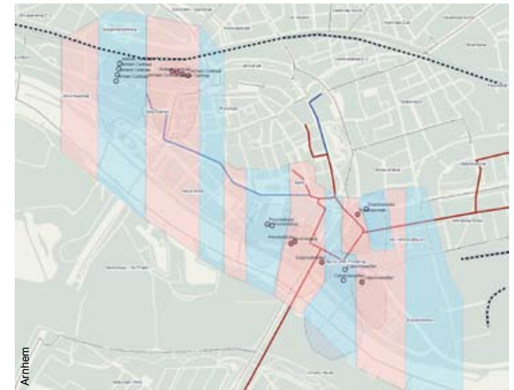
Het masterplan voor warmte-/koudeopslag – lichtblauwe zones voor koudeopslag en lichtrode zones voor warmteopslag – voor het centrum van Arnhem maakt het mogelijk optimaal gebruik te maken van de beschikbare capaciteit.
